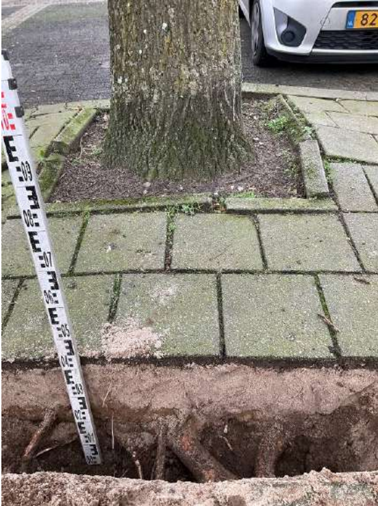
Foto 5 en 6: Beeld van het bewortelingprofiel bij de moseik met boomnummer 3 aan de Prins Hendrikstraat (links) en haagbeuk met boomnummer 15 aan de Patrijsstraat (rechts).
