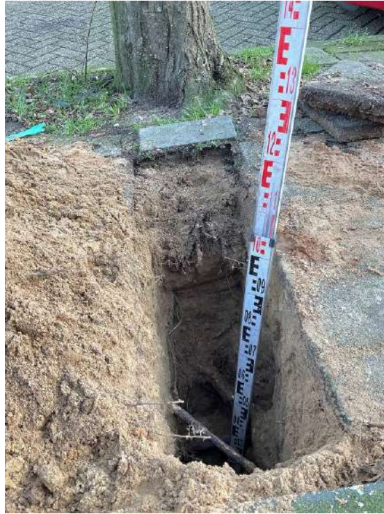
Foto 5 en 6: Beeld van het bewortelingprofiel bij de moseik met boomnummer 3 aan de Prins Hendrikstraat (links) en haagbeuk met boomnummer 15 aan de Patrijsstraat (rechts).
